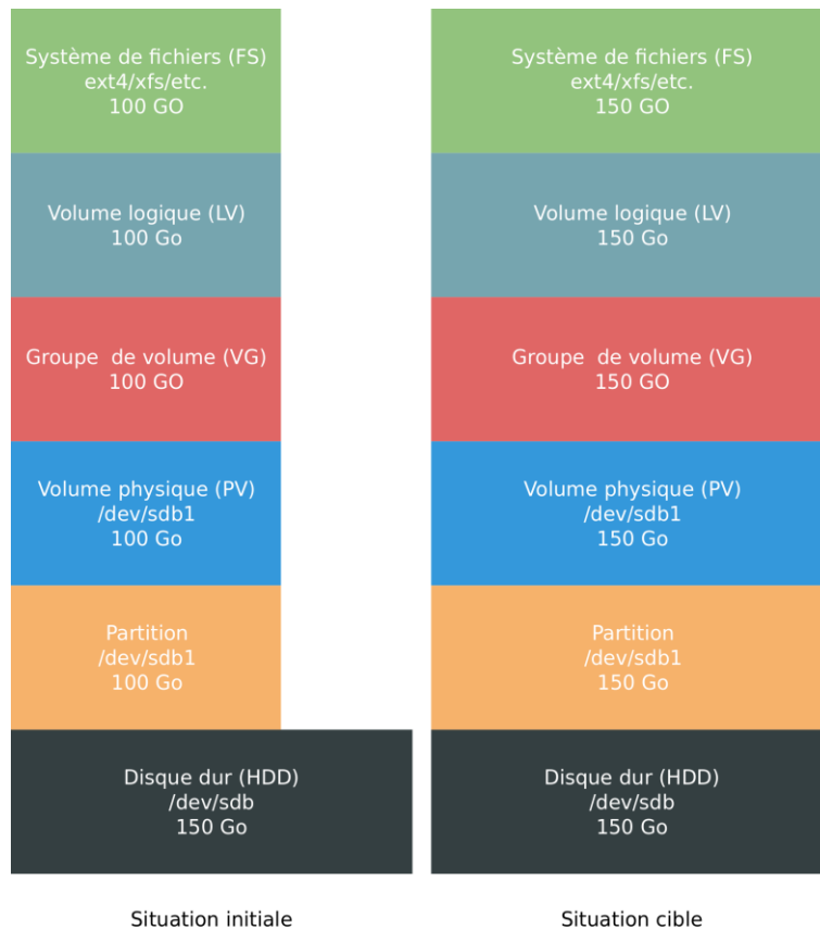
Figure 17 – Agrandissement d'une partition et d'un volume LVM avant/après
