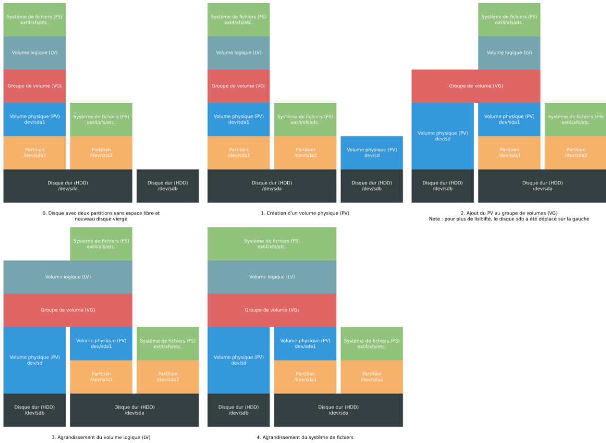
Figure 14 – Agrandissement d'un système de fichiers avec LVM avec un nouveau disque
